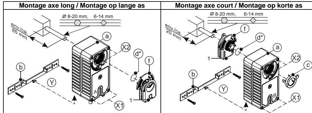
\* Anneau de montage pour une fixation indesserrable de l'adaptateur de serrage sur le moteur. / Montagering voor niet los te maken bevestiging van de klemadapter op de aandrijving.
