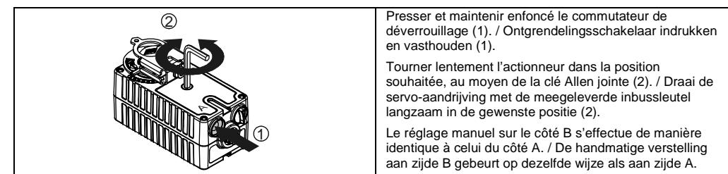
Presser et maintenir enfoncé le commutateur de déverrouillage (1). / Ontgrendelingsschakelaar indrukken en vasthouden (1).
