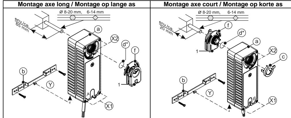
\* Anneau de montage pour une fixation indesserrable de l'adaptateur de serrage sur le moteur. / Montagering voor niet los te maken bevestiging van de klemadapter op de aandrijving.
