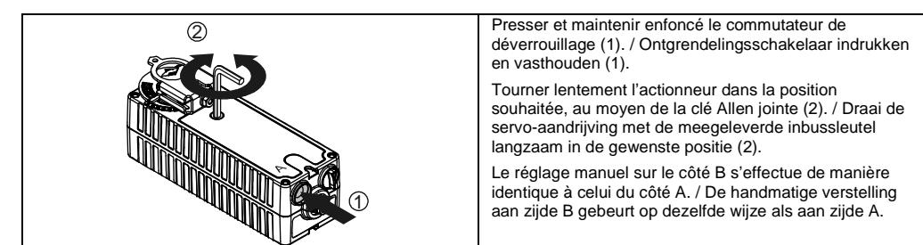
Presser et maintenir enfoncé le commutateur de déverrouillage (1). / Ontgrendelingsschakelaar indrukken en vasthouden (1).
