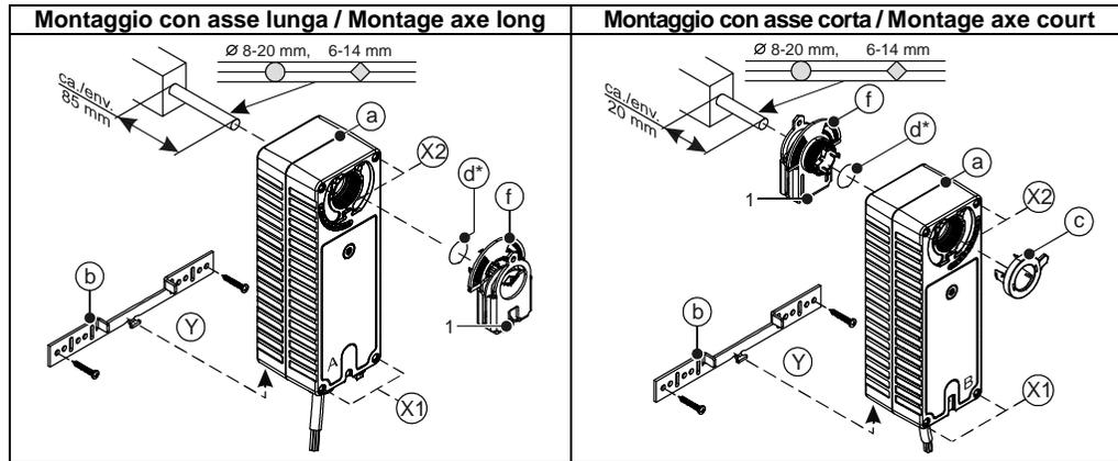
\* Anello di montaggio per fissaggio permanente dell'adattatore a serraggio all'attuatore. / Anneau de montage pour une fixation indesserrable de l'adaptateur de serrage sur le moteur.
